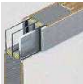
Dwukomorowe przeszklenie antyłamaniowe klasy P4 i ramka ze stali nierdzewnej
