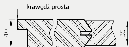
Przekrój poziomy drzwi Elsa
