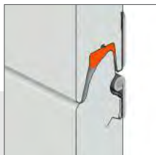
Panel grubości 40 mm. U=1,12 \text{ [W/m}^2\text{K]}^*
